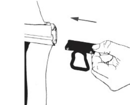
22) Déverrouillez le verrou du bras avec le bouton et accrochez la partie supérieure du bras (crochet) à l'œillet dans la barre de charge.
