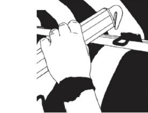
23) Fixez les œilletons dans la barre de charge avec les vis.
